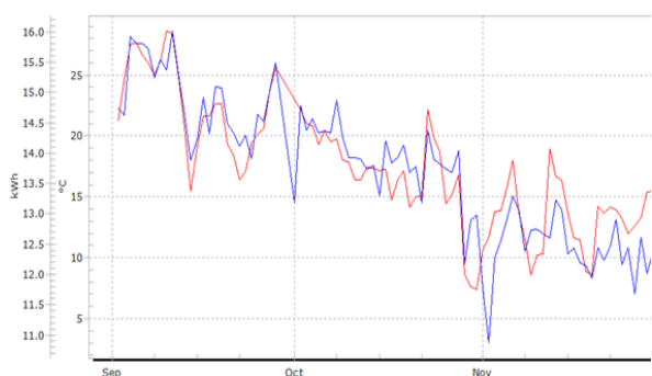
Slika 5: poraba energije celotnega minus nivoja enega od nakupovalnih centrov ter pripadajoča zunanja temperatura med septembrom in decembrom 2012
